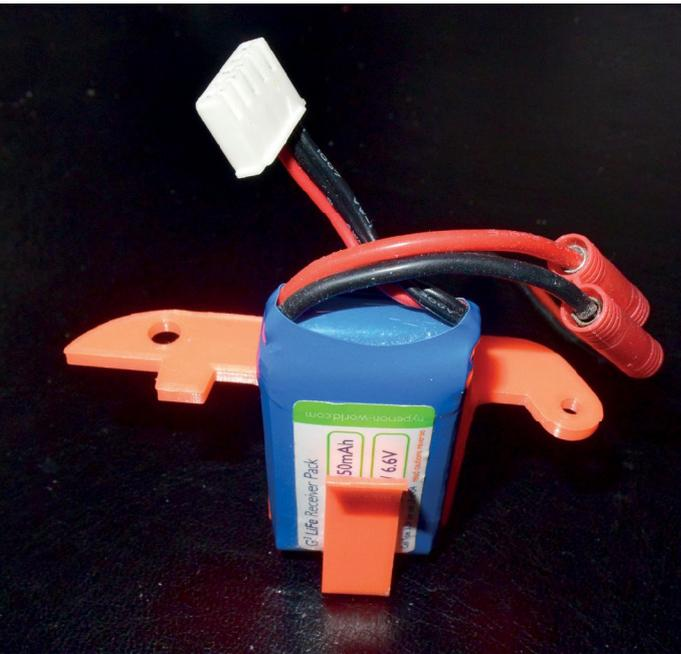
**Abb. 20:** Die Akkuhalterung, die gleichzeitig auch die Lagerung für das Schottröhrchen darstellt, ist eigentlich für NiMH-Zellen gedacht
