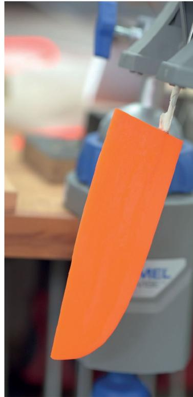
Abb. 15: Da PETG leicht durchscheinend ist, kann man gut die gekröpfte Ruderwelle und den zur Stabilisierung der Fläche eingelegten Kohlestab erkennen
