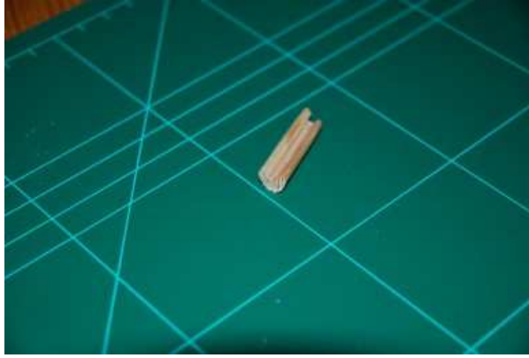
Der Fockbaum (rechts) ist aus 4 Einzelleisten verleimt, deren innere Ecke abgehobelt wurde bei Zusammenleimen entsteht so die Keep im Inneren des Baumes.
