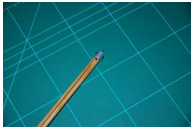
Der Fockbaum (rechts) ist aus 4 Einzelleisten verleimt, deren innere Ecke abgehobelt wurde bei Zusammenleimen entsteht so die Keep im Inneren des Baumes.
