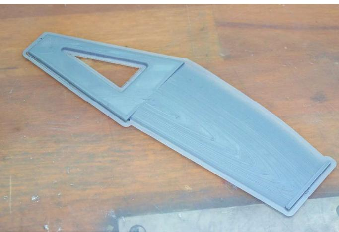
Abb. 11: Eine Kielflossenhälfte für die MM. Gut zu erkennen sind die durch die einzelnen Schichten hervorgerufenen Stufen in der Oberfläche, obwohl diese nur 0,1 mm dick sind
