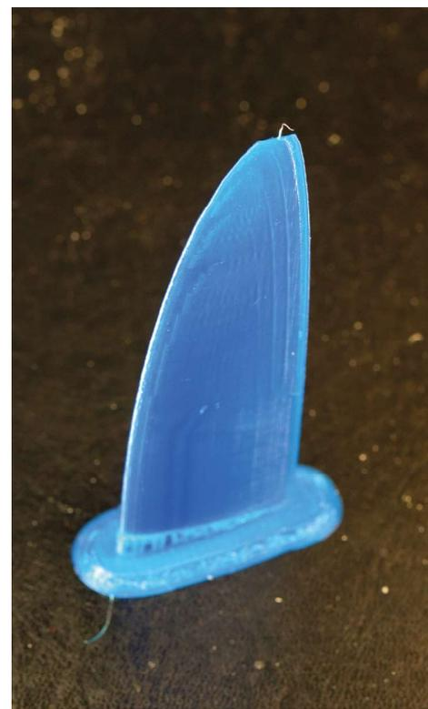
Abb. 8a: Das Bild zeigt ein Ruder während des Druckvorganges in einem HEVO. Für eine bessere Druckbetthaftung wurden Brim und Raft benutzt.
