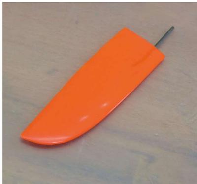
Abb. 10a: Nach dem Verschleifen wird das Ruderblatt beidseitig mit Epoxidharz und einem 25-g/m<sup>2</sup>-Glasgewebe belegt. Das glättet die letzten Stufen und macht die scharf auslaufende Hinterkante stabil
