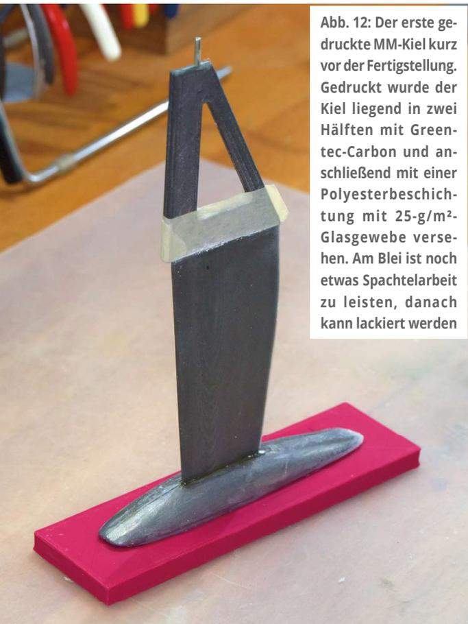
Abb. 12: Der erste gedruckte MM-Kiel kurz vor der Fertigstellung. Gedruckt wurde der Kiel liegend in zwei Hälften mit Greentec-Carbon und anschließend mit einer Polyesterbeschichtung mit 25-g/m<sup>2</sup>-Glasgewebe versehen. Am Blei ist noch etwas Spachtelarbeit zu leisten, danach kann lackiert werden
